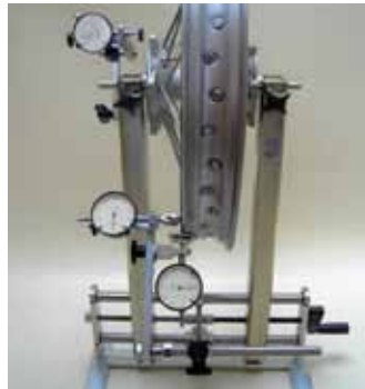
Model Motorfiets Schroefbare asklem · Spanwijdte 300 mm · met adapter voor bevestigingspunten wiel · Toebehoren remschijvenmeter · ook geschikt voor fietsen
