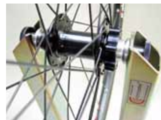
Soporte para ejes delanteros universales hasta D 28mm
