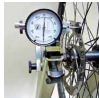
Appareil de mesure pour disques de frein Modèle Comfort uniquement
