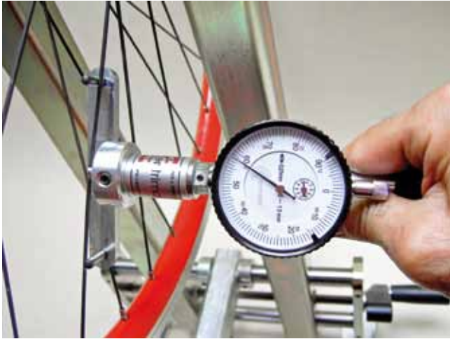
Tensiomètre avec liste de calibration, également pour rayons plats
