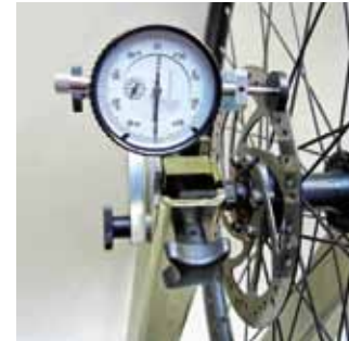
Dispositivo di misurazione dischi dei freni solo Modello Comfort
